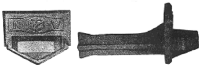
Aspect d'un repère de nivellement : vue de face et de profil
